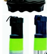
**Ponorná vodárna DEEP a DEEP-R** ponorná vodárna osazená v nádrži nebo ve studně. Elektronický systém udržuje konstantní tlak ve vedení a chrání čerpadlo proti běhu na sucho. Voda je nasávána přes filtrační koš ve spodní části čerpadla nebo z boku pomocí plovoucího sání u typu R.
